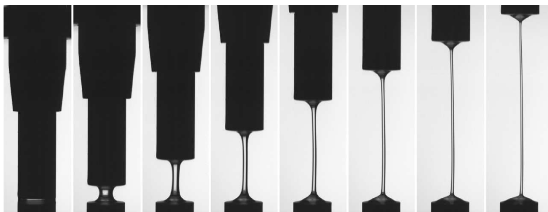
FIGURE 4 : Même expérience reproduite avec une huile siliconée, 100 fois plus visqueuse que l'eau, mais une tension de surface avec l'air comparable. Le temps typique de rupture (de l'ordre de 1 s) est tellement long que le fluide ne se détache pas des rondins. Photographies issues de E. Villermaux, C. R. Mecanique 340 (2012) 555–564.
